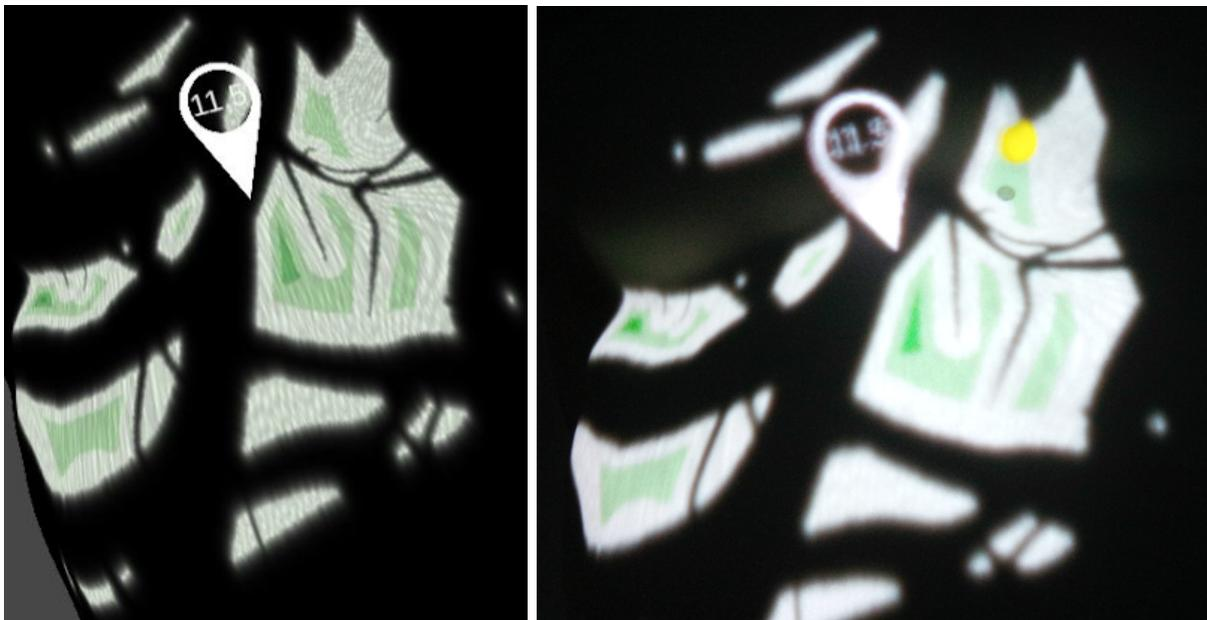
**Abbildung 4.7:** Darstellung des Positions-Pins mit der Einstichvisualisierung in Unity (links) und mit der Projektion (rechts). Die Visualisierung setzt sich aus einem weißen, immer zur betrachtenden Person orientierten, Positions-Pin und einer Zahl zur Tiefenangabe zusammen. Bei dem rechten Bild ist zu beachten, dass das Foto leicht unscharf ist.
